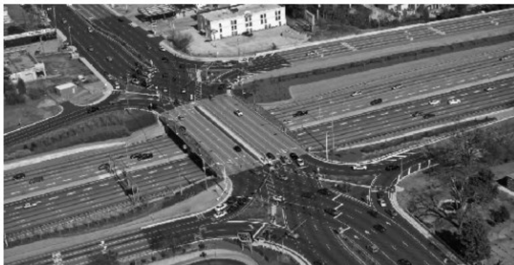
Рис. 3. Ромбовидное пересечение с изменением сторон движения [4]
