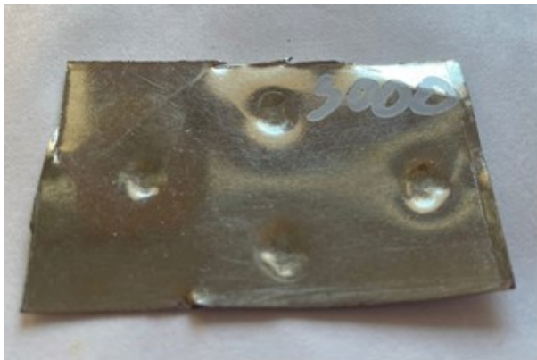
Рис. 8. Часть листа после образования термоконтактной поверхности, подача 3000 мм/мин
